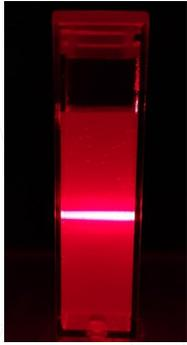
**Figura 5.** Haz de luz producido por un diodo láser de 660 nm de longitud de onda y potencia de 5mW (un apuntador láser común y corriente) que atraviesa de izquierda a derecha a una suspensión de partículas de poliestireno de 100 nm de diámetro. El haz no es visible ni antes ni después de atravesar la muestra, sólo se observa la luz producida por la dispersión Rayleigh debido a la presencia de las partículas coloidales.
