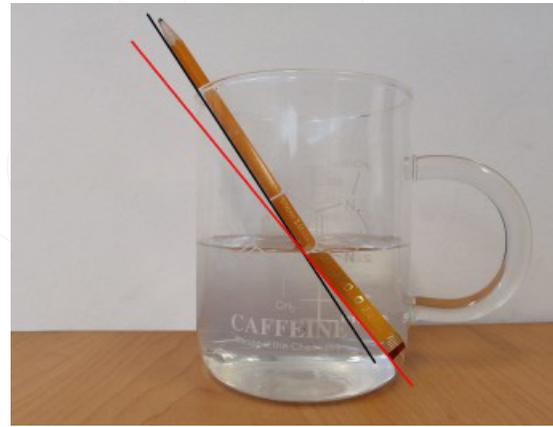
**Figura 6.** Foto de un lápiz parcialmente sumergido en agua. Se han trazado un par de rectas para guiar al ojo y resaltar el ángulo de refracción que aparece entre lo que se observa fuera y dentro del agua (negro fuera, rojo dentro). El mismo fenómeno ocurre con los rayos solares que ingresan a la atmósfera y se curvan debido a su gradiente en el índice de refracción. Esto hace que podamos ver al Sol antes de que éste se encuentre físicamente sobre el horizonte.
