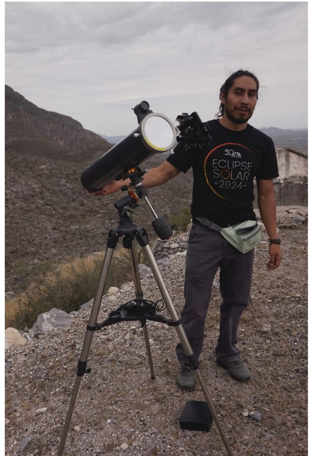
**Figura 3.** Telescopio con montura ecuatorial, balanceado, con filtro de hidrógeno-alpha ( $H\alpha$ ), adaptador y teléfono móvil montado junto a uno de los autores (Sergio Islas Ramírez). En la imagen se aprecia el paisaje del terreno desde el cual se realizó la observación.
