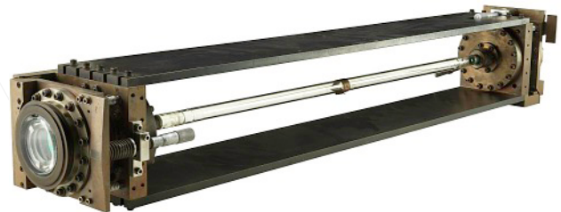
Figura 4. Primer prototipo de un láser funcional de helio-neón. Nota. Reproducida de National Museum of American History, 2024.
